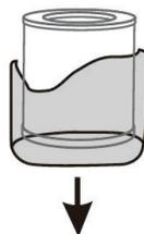
4. Setzen Sie den Filter wieder ein. Bringen Sie den Filterdeckel wieder an und drehen Sie ihn nach rechts, um ihn zu verriegeln. Richten Sie die Pfeile aus, um den Filter zu verriegeln.
