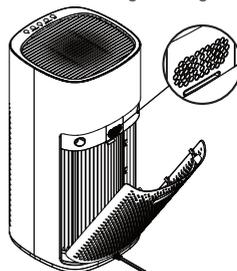
1. Verwenden Sie eine weiche Bürste, um den Ein- und den Ausgang des Luftqualitätsindikators zu reinigen.
